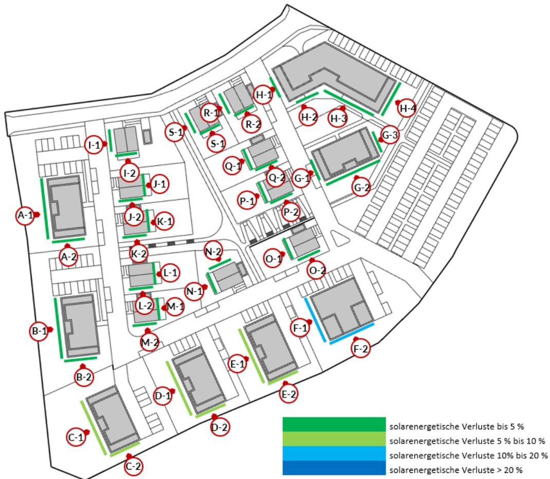
Abbildung 7.7: Solarenergetische Verluste durch Orientierung und Verschattung
