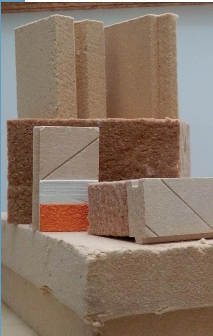
Abb. 18 Holzfaserdämmung
